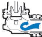
**Cerrada** –La válvula principal se mantiene cerrada mediante la tuerca de operación y la presión del agua; el barril está seco.
