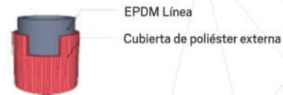
La manguera para gabinete SERIE FAS está construida de una capa de fibra de poliéster y tubo interior de E.P.D.M.
