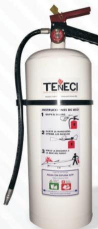
El extintor de agua con espuma AFFF es ideal para fuegos tipo A y B, sobre todo en la clase B Líquidos inflamables ya que deja una película de espuma encima del liquido prendido sofocándolo. En alcoholes es al 6% Hidrocarburos es al 3%
