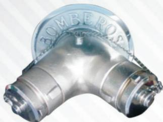
401 Toma siamesa cromada, fabricada en bronce con entradas hembras giratoria de 2 1/2 NST y salida de 4" NPT con tapones y cadena, para colocarse a la red de hidrantes con placa cromada con la leyenda BOMBEROS.
